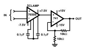
FIGURE 4. USING 741 TO BOOST OUTPUT DRIVE CAPACITY
