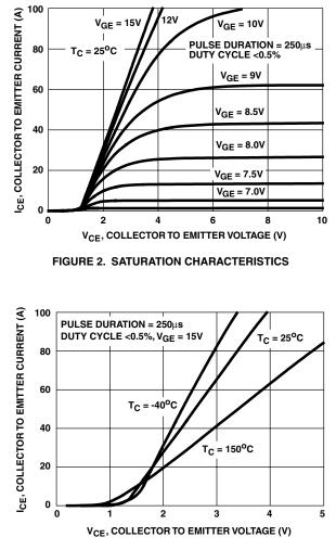
FIGURE 4. COLLECTOR TO EMITTER ON-STATE VOLTAGE
